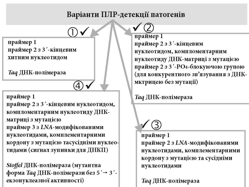
Рис. 1. Варіанти алель-специфічної ПЛР, що використовували (за винятком 4) для диференціації МТК та протеїв (1), детекції чутливих/резистентних до ізоніазиду МТБ (2), а також для визначення точкових мутацій в геномі МТБ (3).
